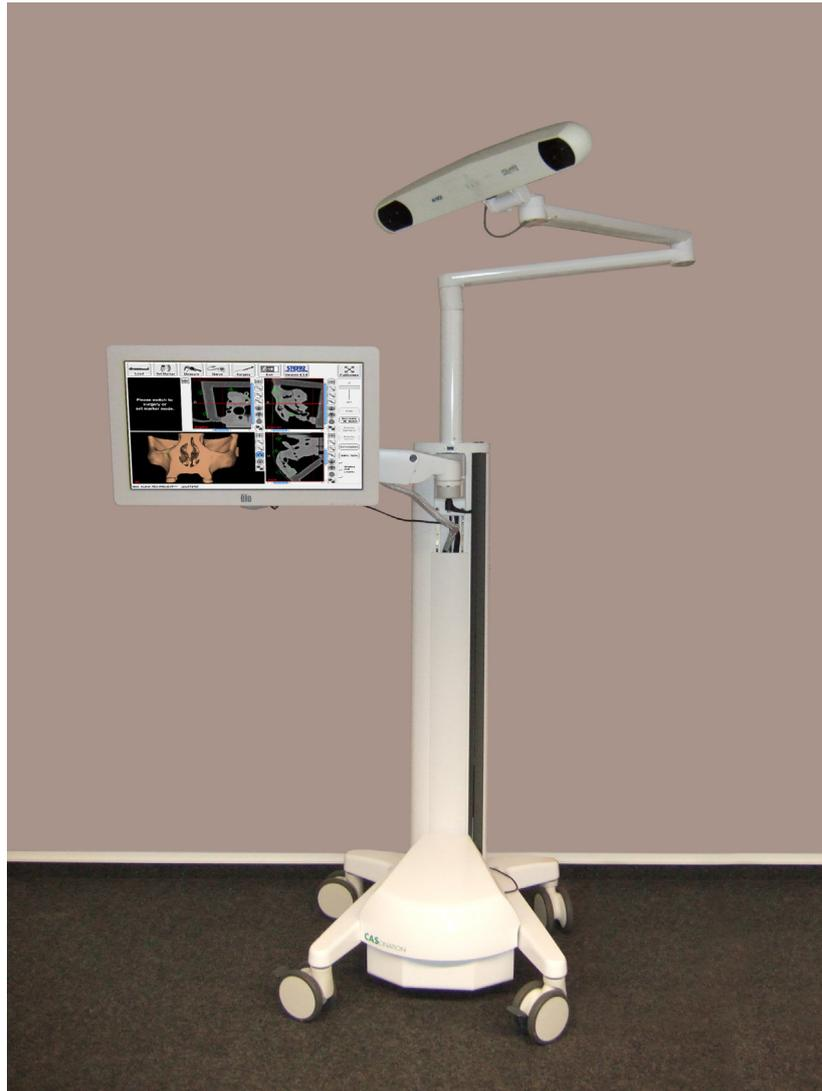
**Abbildung 2: IGN-Einheit mit Stereokamera und Navigationsbildschirm**
