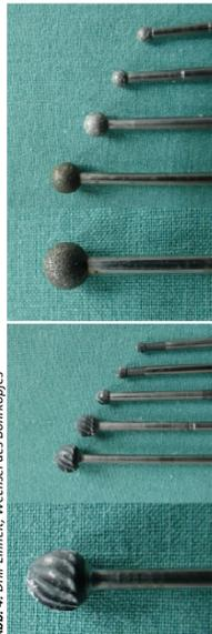
Abb. 5: Rosenbohrer (links) und Diamantbohrer (rechts), in verschiedenen Grössen
