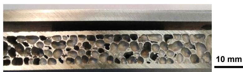
**Abbildung 3-37 – Vormaterial (oben) und geschäumte Platte (unten) des Aluminium-Foam-Sandwich (AFS®) der *pohltec metalfoam GmbH*.**
