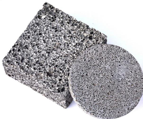
**Abbildung 1-2 – Bild zweier zellulärer Metalle, links Metallschaum, rechts Metallschwamm.**
