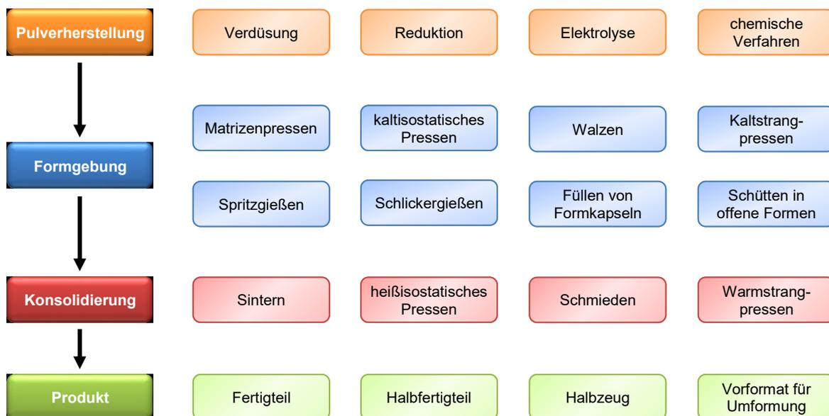
Abbildung 1-4 – Verfahrensschritte in der Pulvermetallurgie, nach [25]
