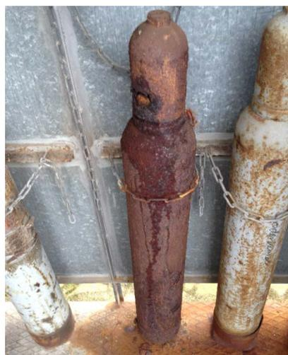
Bild 29: Stark korrodierte Druckgasflaschen mit gefährlichem Inhalt
