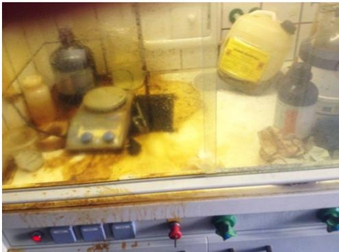
Bild 28: Verpuffungsschaden im Labor
