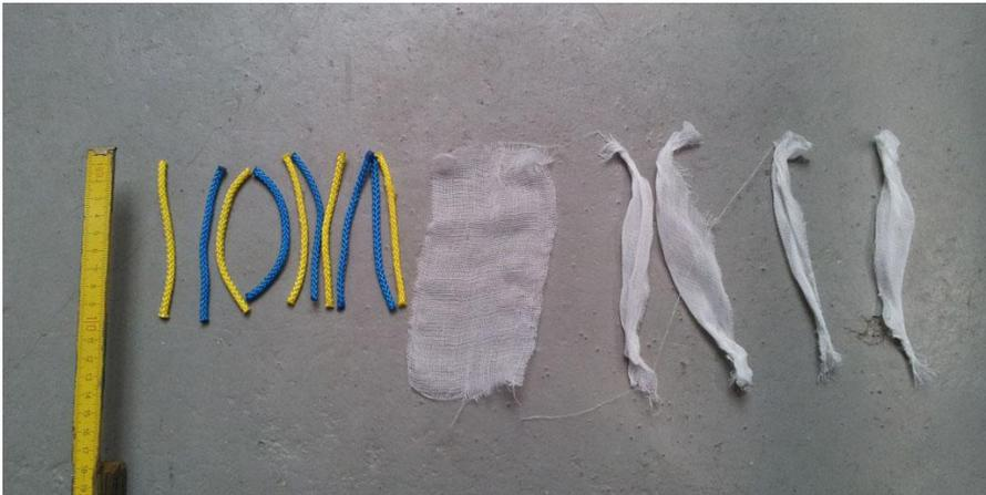
**Bild. 6.21.** Feststoffe für Simulation des Abwassers für Untersuchung des *Bypasses*
