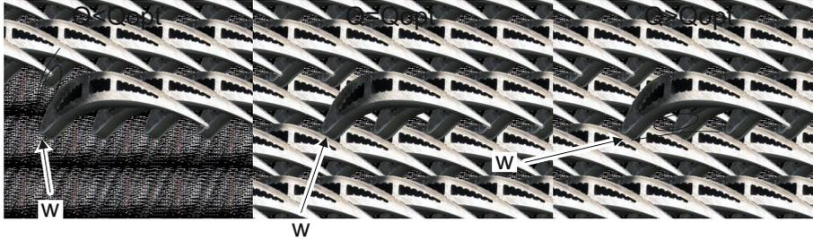
**Bild. 4.4.** schematische Darstellung der Beaufschlagung der Schaufeleintrittskante und Strömungsablösung bei Teillast, Bestpunkt und Überlast einer Pumpe
