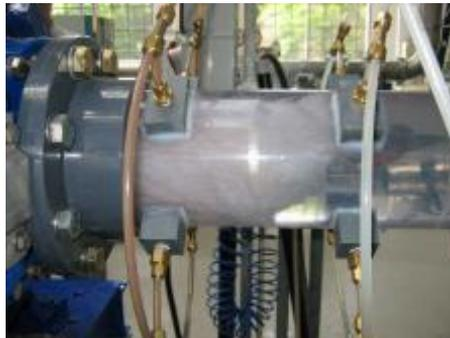
**Bild. 5.8.** Verstopfung im Saugrohr bei Modellversuchen
