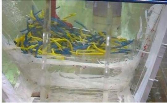
**Bild. 6.24.** Betriebspunkt Nacht. Feststoffablagerung im Saugraum
