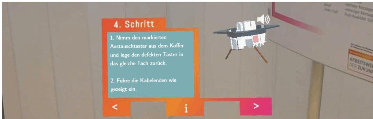
Abbildung 7.18: Einblendung von Animationen und Zusatzinformationen mithilfe der HoloLens
