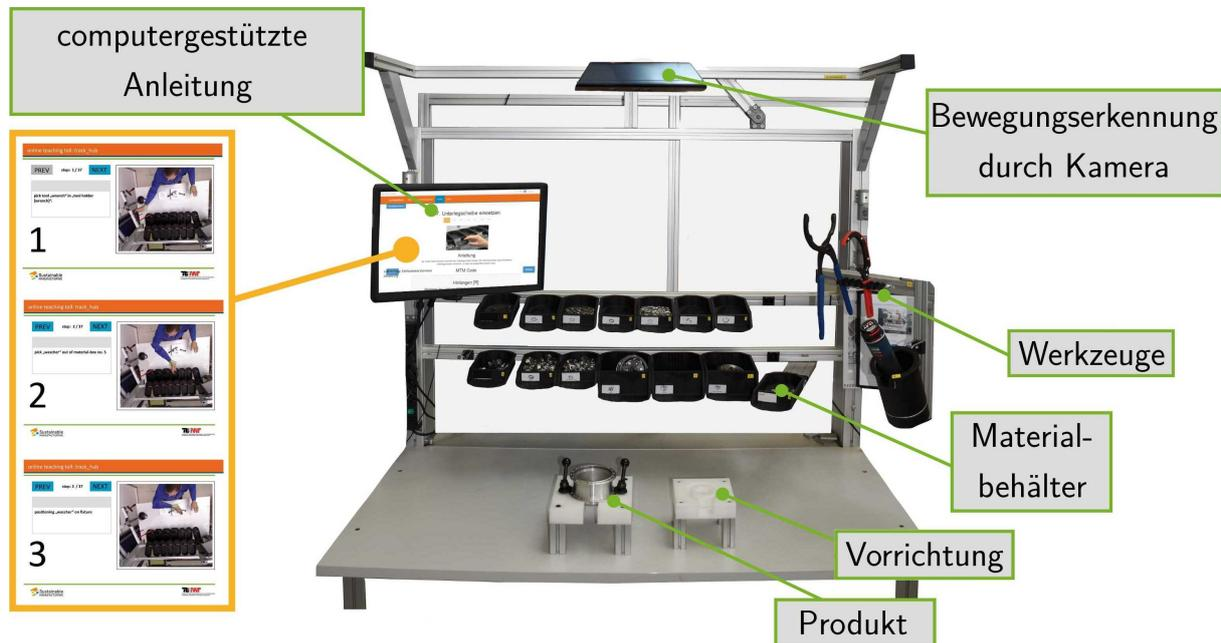
Abbildung 3.6: Smart Assembly Workplace (SAW) nach [McF-13, Pos-13, Mül-16a]
