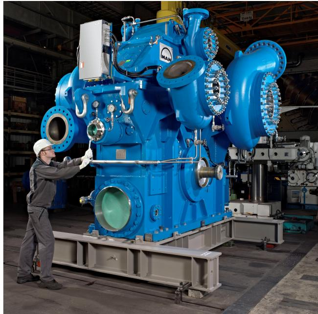
Abbildung 7.1: Montage eines Getriebekompressors mit freundlicher Genehmigung von MAN ES Energy Solutions SE
