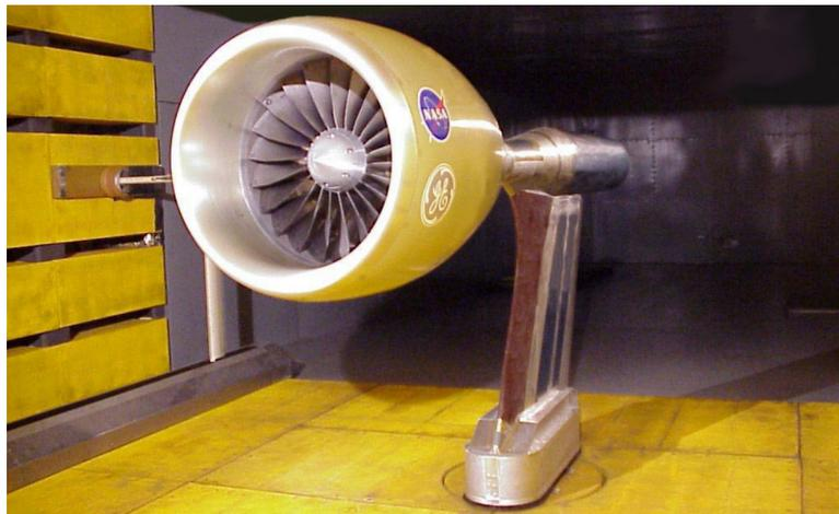
**Abbildung 3.16:** SDT-Prüfstand im LSWT des NASA Glenn Research Center. Bild mit freundlicher Genehmigung der NASA (Envia et al., 2008).
