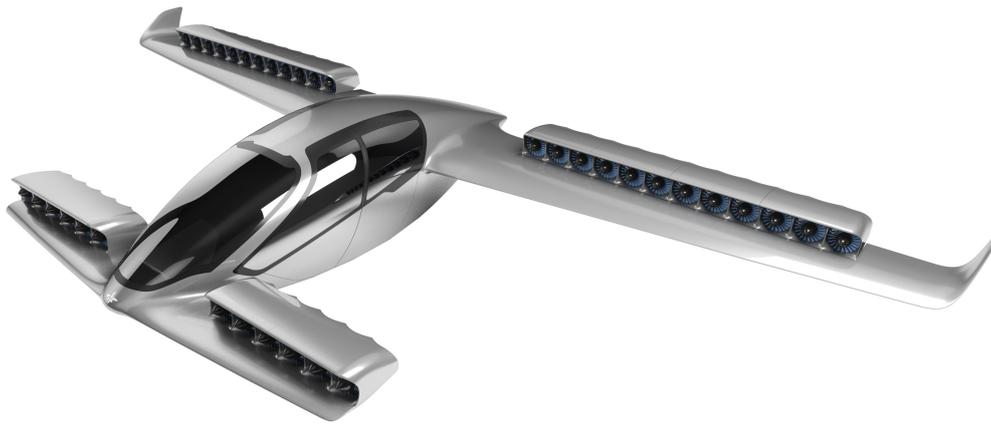
**Abbildung 1.4:** Konzept eines batteriebetriebenen Flugzeugs für 5 Personen mit 36 verteilten Fanstufen. Mit freundlicher Genehmigung der Lilium GmbH.
