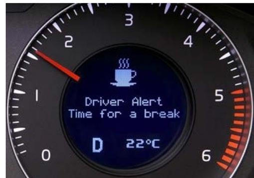
Abbildung 10. Visuelle Warnmeldung des Systems Driver Alert Control (Bild: <https://www.media.volvocars.com>; Abdruck mit Genehmigung der Volvo Car Corp.)
