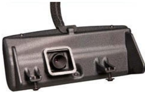
Abbildung 5. *SafeTRAK*-System mit Straßenkamera zur Erfassung von Spurhaltungsmaßen. (Bild: <http://www.safetrak.takata.com>, Abdruck mit freundlicher Genehmigung der Takata Corp.)
