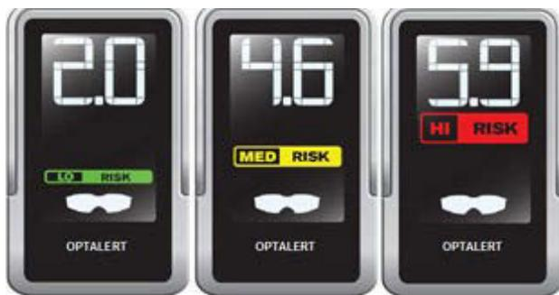
Abbildung 7. Grafische Rückmeldungen des Optalert-Systems auf verschiedenen Müdigkeitsstufen. (Bild: <http://www.optalert.com>; Abdruck mit Genehmigung der Optalert Pty. Ltd.)
