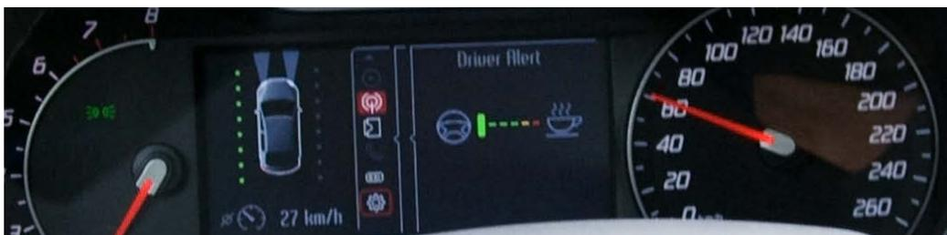
Abbildung 11. Integration der visuellen Statusrückmeldung des Driver Alert (Mitte) in andere Fahrzeuganzeigen. (Bild: Ford, Abdruck mit Genehmigung der Ford Motor Company)
