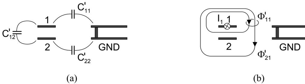
Abbildung 6.8: Bedeutung der Kapazitätskoeffizienten  $C_{ik}$  (a) und der Induktivitätskoeffizienten  $L'_{ik} = \Phi'_{ik}/I_k$  (b).
