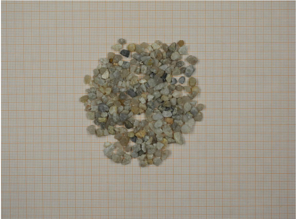
Abbildung F.2.5: Aufnahme von 20 g Filterkies (3,15-5,6 mm) auf Millimeterpapier
