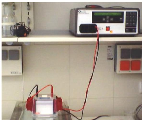
**Abb. 4-3: MIGHTY SMALL II S250 Trennkammer und MultiDriveXL Stromversorgungsgerät**
