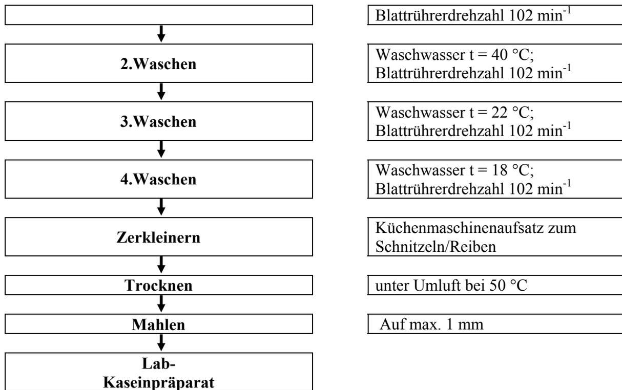
**Abb. 5-1: Fließbild zur Herstellung von Labkasein im Labormaßstab**
