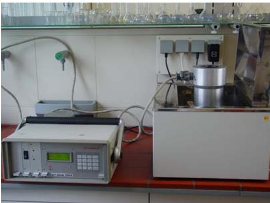
**Abb. 4-2: Messanordnung zur Bestimmung von Prozessviskosität nach der Einlabung der Untersuchungsmilch**
