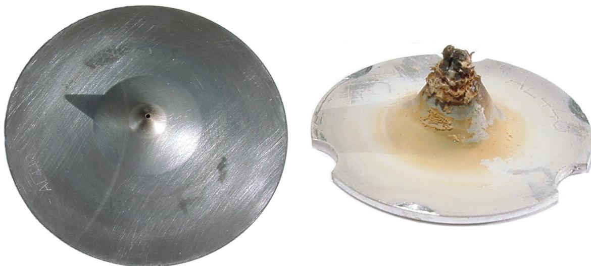
**Abbildung 5-12:** *Sampler und verstopfter Skimmer nach Messung der Aufschlußlösung ohne Verdünnung*
