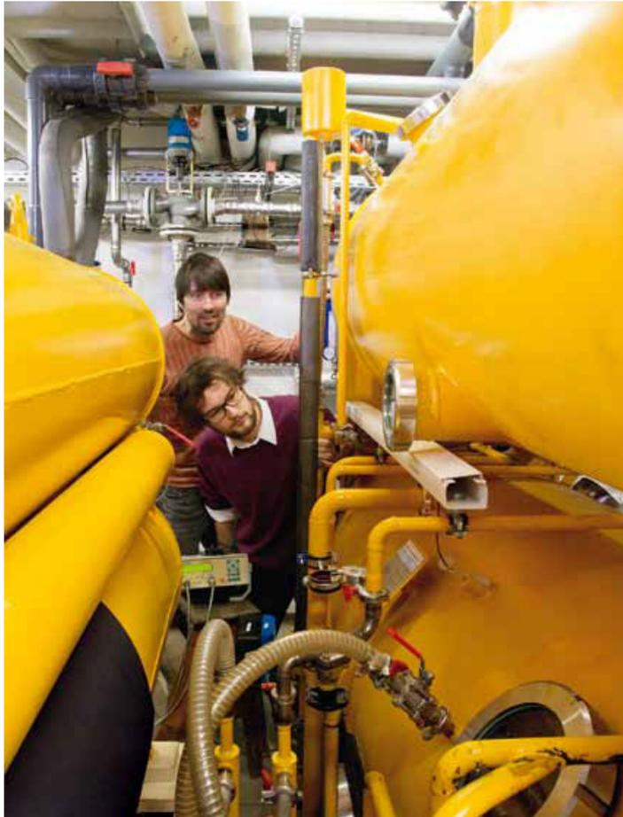
Den Prototyp einer Absorptionskälteanlage haben Wissenschaftler der TU Berlin zusammen mit Partnern entwickelt. Absorptionskälteanlagen sind Systeme, die Wärme in Kälte umwandeln
