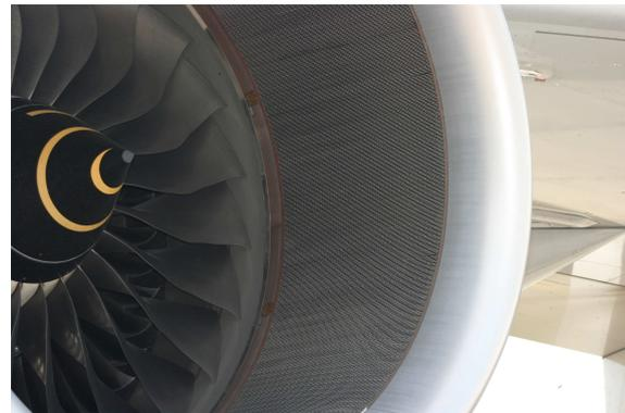
(b) Beispiel für einen aktuellen Triebwerkseinlauf mit Liner ohne Splices. (Foto: L. Panek)
