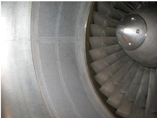
(a) Beispiel für einen Triebwerkseinlauf mit älterem Liner mit Splices.
