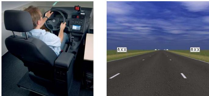
Abbildung 6.16: Das Bild links zeigt die in Experiment 2 verwendete Sitzkiste und rechts die Streckenansicht der Fahrsimulation im LCT.
