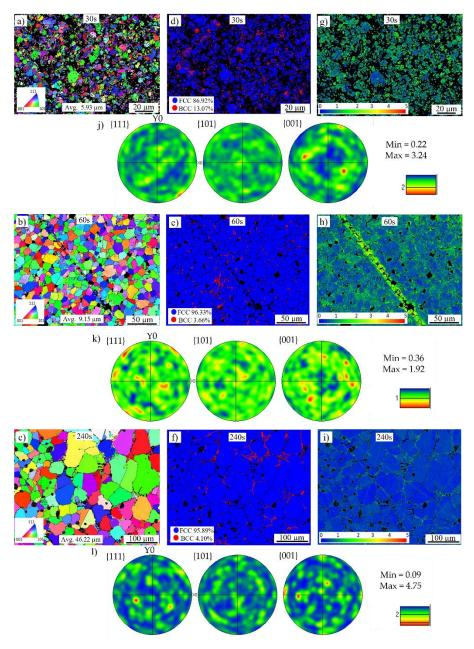
**Figure 10.** EBSD maps of the refractory ballast sintered specimens after (**a**) 30 s, (**b**) 60 s, (**c**) 240 s, phase maps of the specimens after (**d**) 30 s, (**e**) 60 s, (**f**) 240 s, local misorientation maps after (**g**) 30 s, (**h**) 60 s, (**i**) 240 s and Euler pole figures after (**j**) 30 s, (**k**) 60 s, and (**l**) 240 s.
