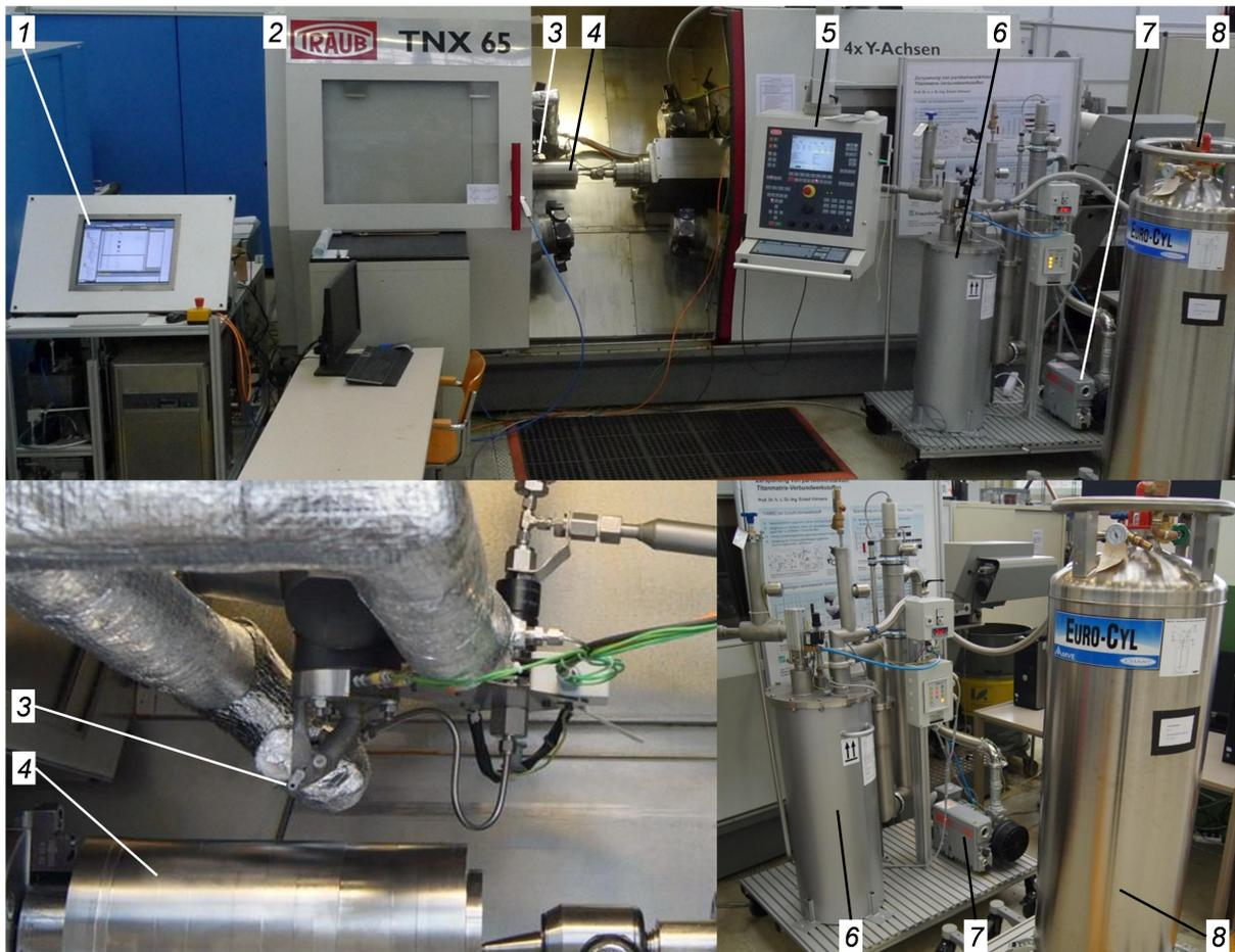
**Bild 4-1:** Anordnung und Aufbau des Versuchsstands. 1 Industrierechner mit softwarebasierter speicherprogrammierbarer Steuerung zur Flüssigstickstoff-Kühlungsregelung und Messwertaufzeichnung, 2 CNC-Dreh-Fräszentrum Traub TNX 65/42, 3 strukturoptimiertes geschlossen-innengekühltes Drehwerkzeug, 4 Werkstück aus TiAl6V4, 5 Bedienpult und Monitor der CNC-Maschinensteuerung, 6 Flüssigstickstoff-Unterkühler STELLA, 7 Vakuumpumpe, 8 Flüssigstickstoffversorgungsbehälter
