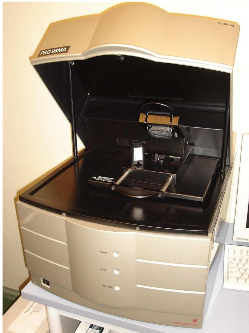
Abb. 1.7 - Pyrosequencer 96MA mit Kartusche. Der Deckel der Dispensationseinheit ist geöffnet, eine gefüllte Kartusche kann eingebaut werden. Darunter befindet sich die Prozesskammer.
