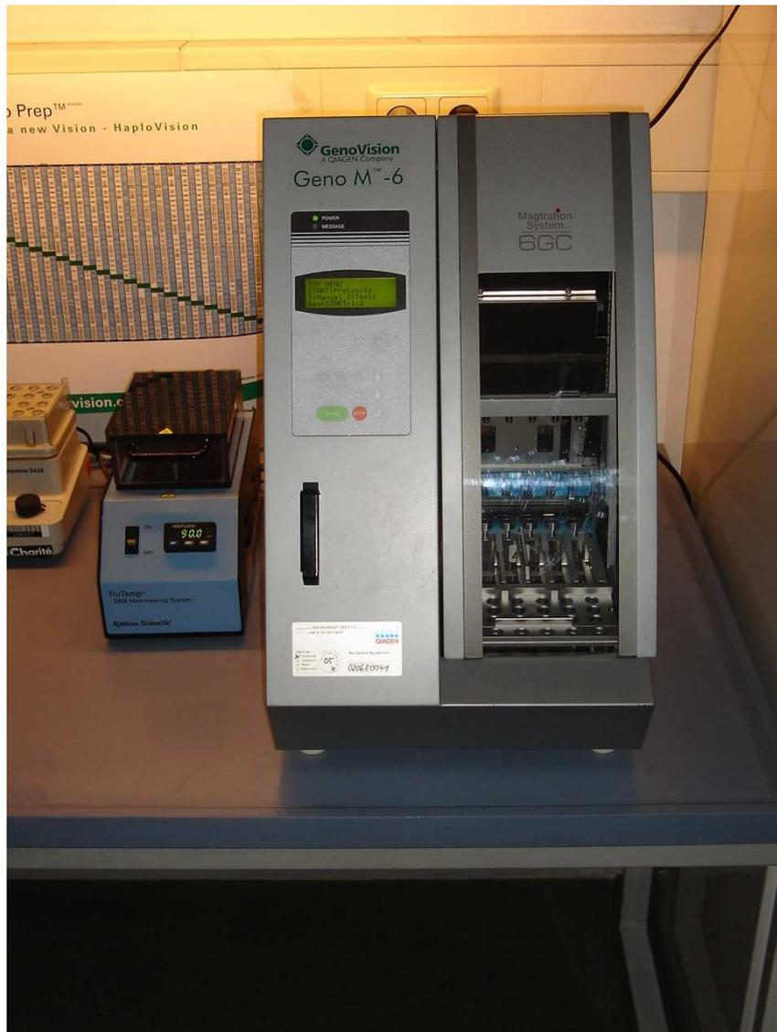
Abb. 2.1 - Geno M-6 Gerät zur vollautomatischen Extraktion von DNA aus Blut und zur Anwendung der Haplotyp-spezifischen Extraktion.
