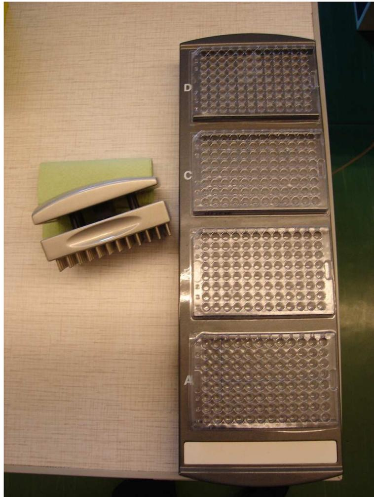
Abb. 2.2 - Pyrosequencing Aufreinigungszubehör. Links das „Sample Prep Tool“ mit 96 magnetischen Stäbchen zur Separation der Dynabeads aus der Lösung, rechts die Halterung für die vier Platten.
