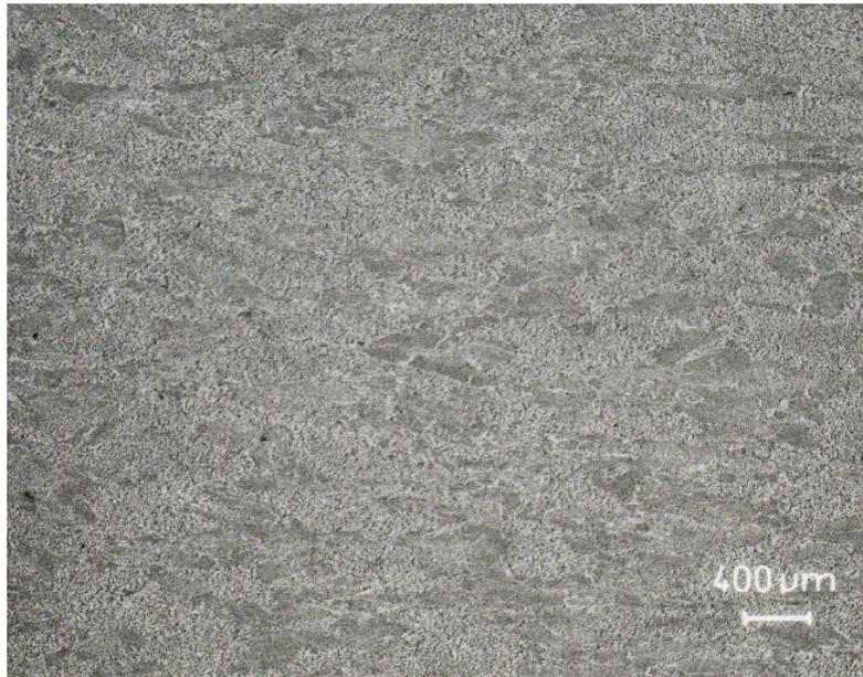
Bild 5.3: Probe 2, Versuch CRU7x046, Temperatur  $T_1$ , Spannung 950 MPa, geringe Auflösung
