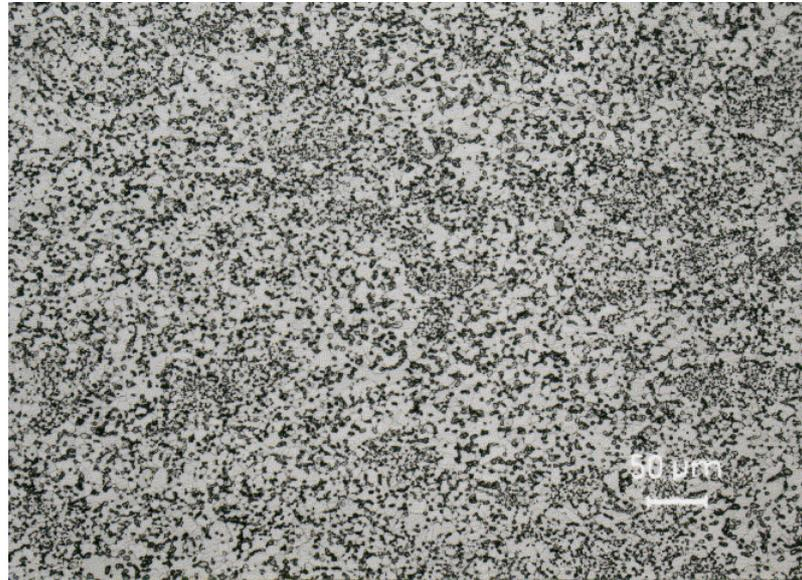
Bild 5.2: Probe 1, Versuch CRU7x046, Temperatur  $T_1$ , Spannung 950 MPa, hohe Auflösung
