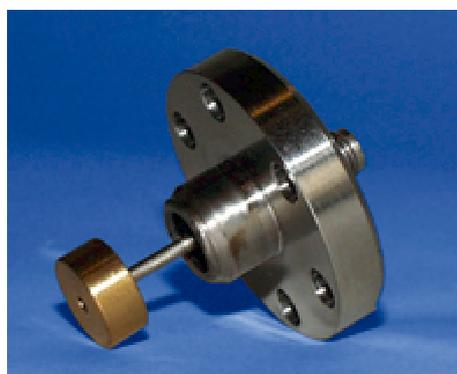
**Abbildung 4.9:** Durchführung mit dem Flansch und der Anpassungsscheibe
