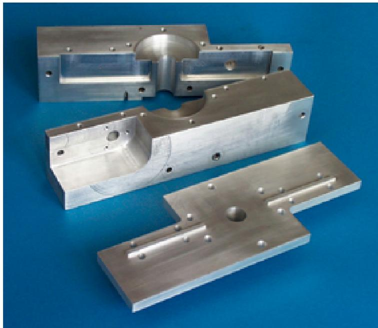
a) Monitorresonator: zwei Teile des Resonatorkörpers und oberer Deckel
