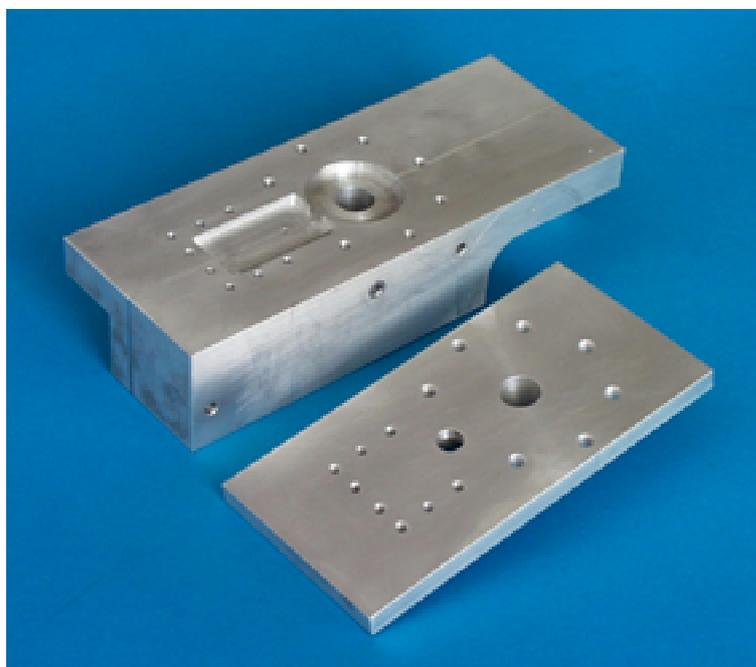
b) Referenzresonator: Resonatorkörper und unterer Deckel
