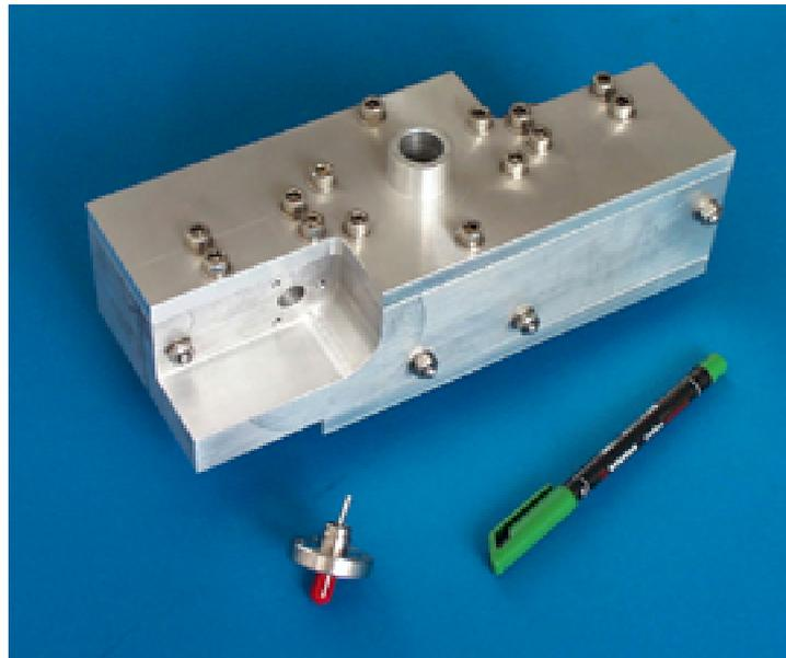
**Abbildung 7.4:** Zusammengebauter 5,5 GHz-Prototyp
