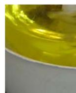
Abb. 6.2-4: Farb-Intensitätsabnahme mit gleichzeitiger Viskositäts-erhöhung nach 15 min (Bildausschnitt)
