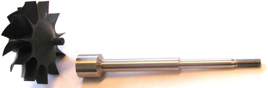
**Abbildung 3.1:** Metallische Welle und keramisches Turbinenlaufrad
