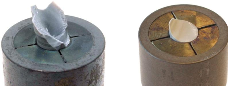
**Abbildung 4.4:** a) Torsionsbruch und b) Biegebruch
