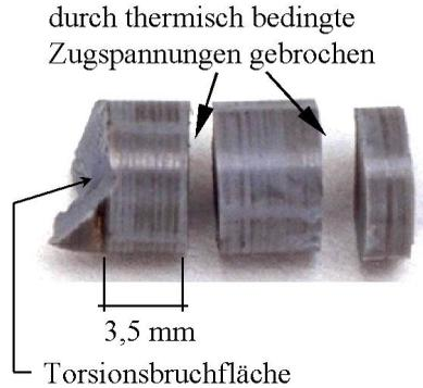
**Abbildung 6.5:** Keramischer Wellenansatz einer nach dem Versuch demonstrierten Torsionsprobe (Variante II-A)
