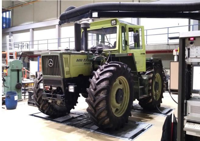
**Abb. 13: TUB-Trac auf dem Fahrbahnsimulator im Labor für Maschinensystem der Technischen Universität Berlin**
