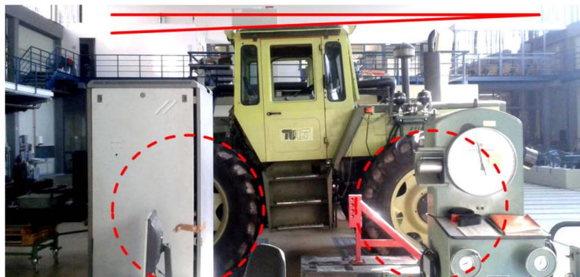
**Abb. 131: Einfederung des TUB-Trac bei Beladung mit dem Anbaugerätesimulator ohne Niveauregulierung (ABG, links)**
