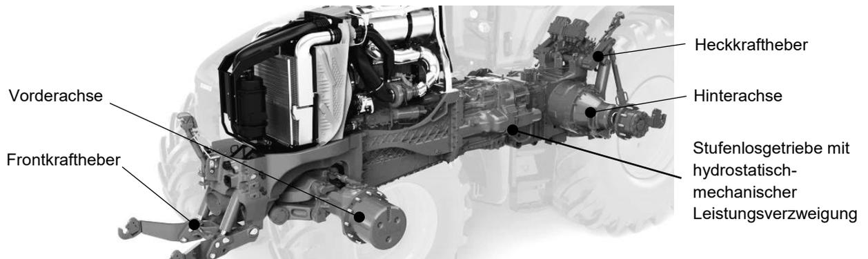
**Abb. 4: Beispiel des Fahrwerks eines Standardtraktors mit einer über Querlenker angeordneten vorderen Starrachse und einer festen Hinterachse in Blockbauweise der Fa. Claas [10]**
