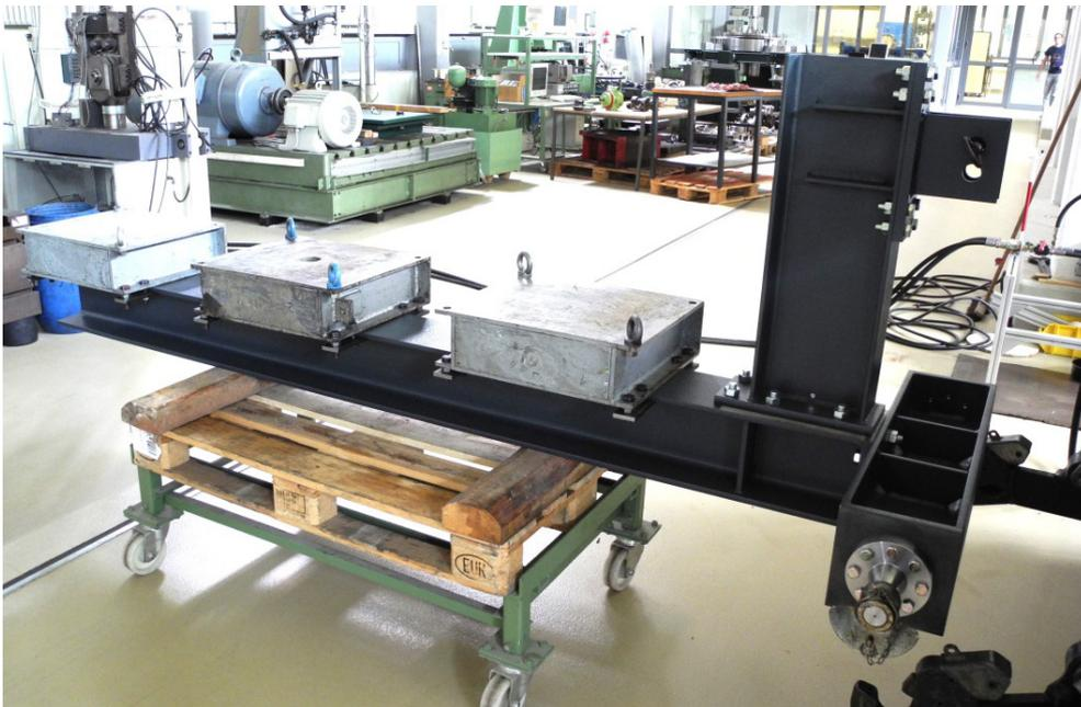
**Abb. 33: Umgesetzter Anbaugerätesimulator mit der für die durchgeführten Versuche verwendeten Massenkombination ( $m = 1030,5\ kg$ ;  $J = 667\ kg\cdot m^2$ )**
