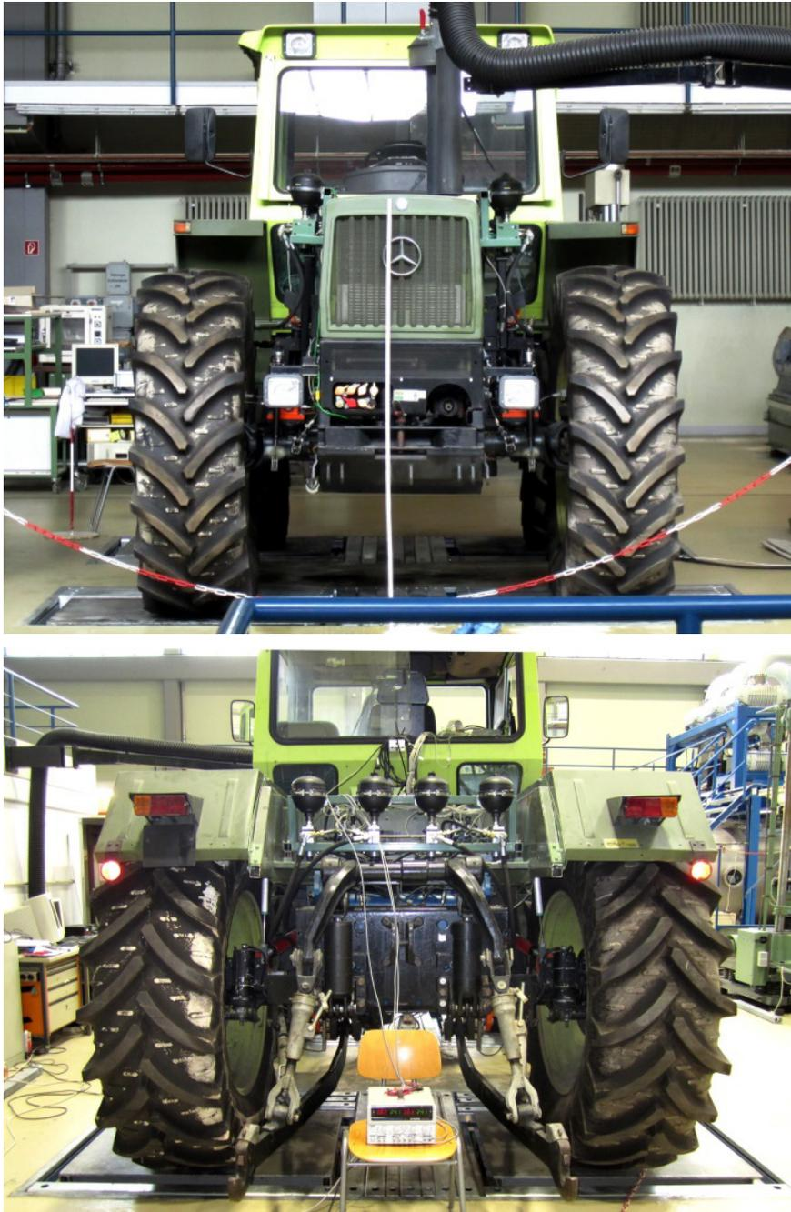
**Abb. 17: Front- (Abbildung, oben) und Heckansicht (Abbildung, unten) des TUB-Trac auf der Hydropulsanlage der Technischen Universität Berlin.**
