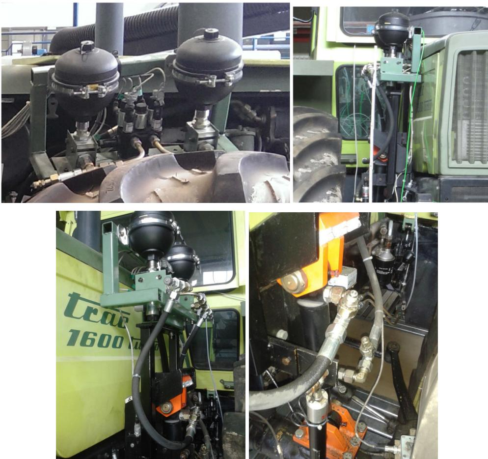
**Abb. 36: Aufbau des hydropneumatischen Federungssystems der Vorderachse des TUB-Trac**
