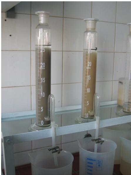
Abb. A3 Atterberg-Zylinder mit aufgeschüttelter Suspension
