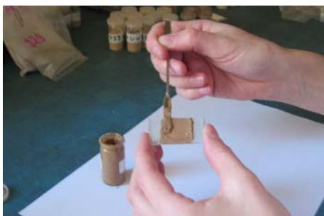
Abb. 13 Anfertigung der Schmierprobe
