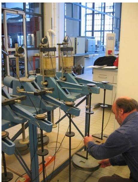
Abb. 48 Prüfaufbau Kriechverformungs-
