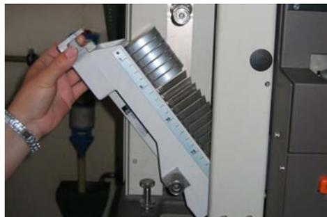
Abb. 17 Einfüllen von Sammelproben in das Röntgendiffraktometer
