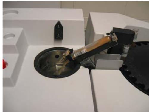
Abb. 9 Einfüllen des Probenmaterials in das Schlauchsystem des Laserdiffraktometers
