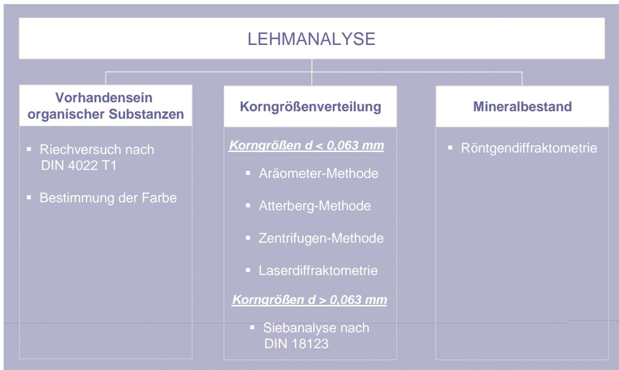
Abb. 2 Gewählte Prüfverfahren für die Untersuchung der Grubenlehme
