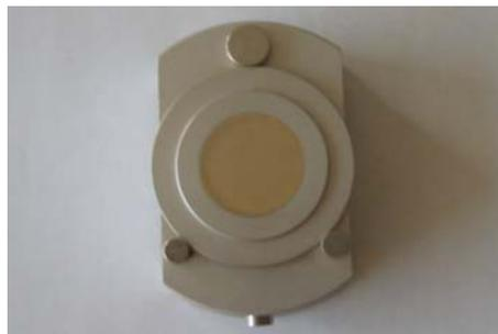
Abb. 16 Pulverpräparat in Probenhalter
