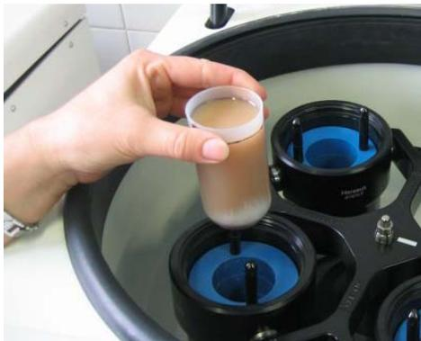
Abb. A5 Einstellen der Probe in die Zentrifuge
