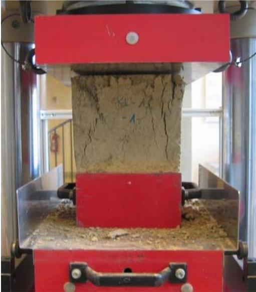
Abb. 40 Probewürfel mit  $a = 20$  cm und Darstellung der Bruchfigur
