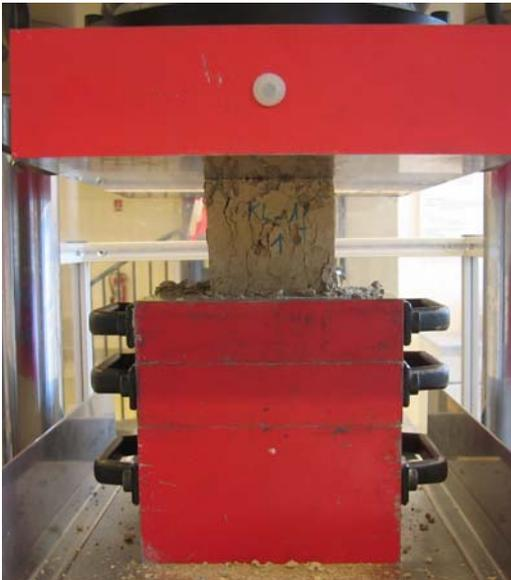
Abb. 42 Probewürfel mit  $a = 10$  cm und Darstellung der Bruchfigur
