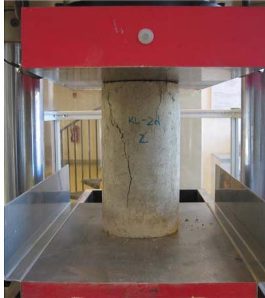
Abb. 41 Probezylinder mit  $d = 15$  cm und Darstellung der Bruchfigur
