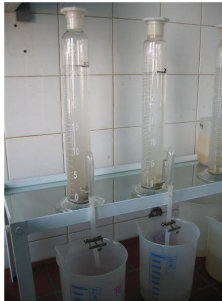
Abb. A4 Atterberg-Zylinder mit fast vollständiger Sedimentation der Teilchen
