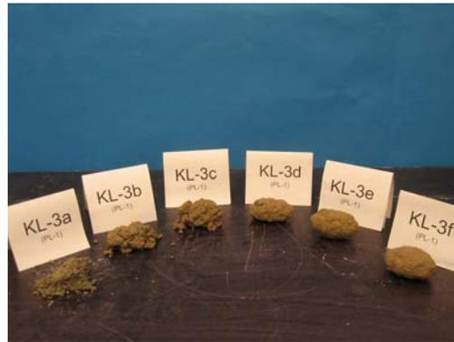
Abb. 60 Knetproben von KL-3a bis KL-3f für die qualitative Zuordnung
