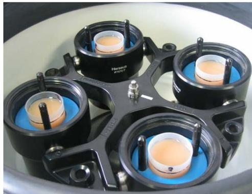
Abb. A6 Anordnung der Zentrifugengefäße in der Zentrifuge
