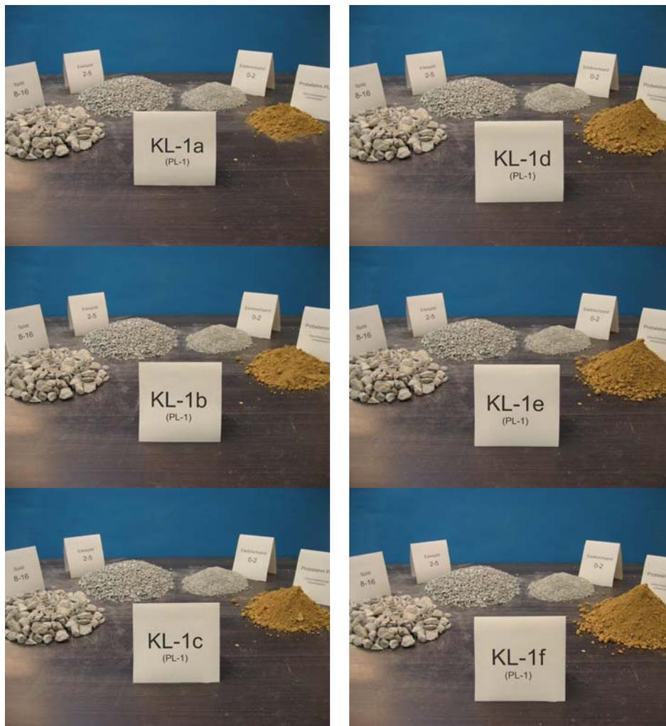
Abb. 58 Darstellung der verwendeten Stoffanteile bzw. der schrittweisen Erhöhung des Naturlehmanteils für die Herstellung der Kornverteilungslinien KL-1a bis KL-1f
