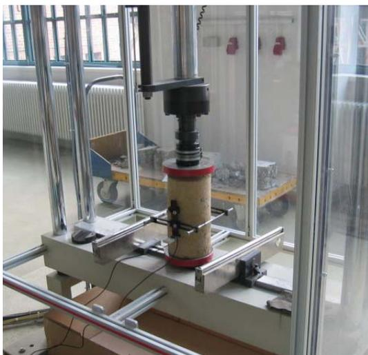
Abb. 43 Prüfaufbau für Elastizitätsmodul-Messung
