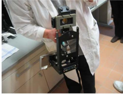
Abb. 7 optische Einheit des Laserdiffraktometers
