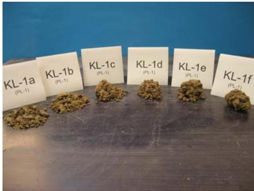
Abb. 59 Knetproben von KL-1a bis KL-1f für die qualitative Zuordnung
