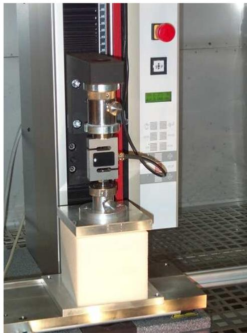
Bild 3.4: Universal-Zug-Druck-Prüfmaschine ZWICKi Z01
