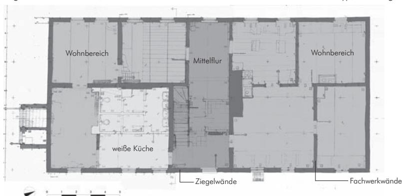
Caputh, Logierhaus, Grundriss Erdgeschoss, Hervorhebung des Mittelflures, der weißen Küche sowie der Fachwerk- und Ziegelwände.
