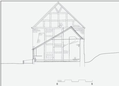
Schnitt C durch das Warmhaus mit Ansicht auf den Ostgiebel des Orangerie West, nach tachymetrischem und photogrammetrisch gestütztem Aufmaß, o. M., im Original M 1:50, 2009.
