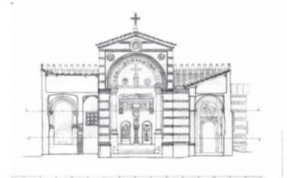
Querschnitt durch Kreuzgänge und Innenhof, Handaufmass und 3D-Laserscanning (Survey Service Leipzig) im Original 1:50, 2009.
