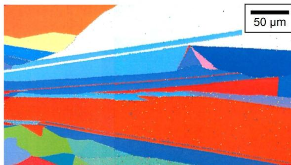
**Abbildung 3.3:** EBSD-Aufnahme einer elektronenstrahlkristallisierten Schicht (aus [Bec2013]).
