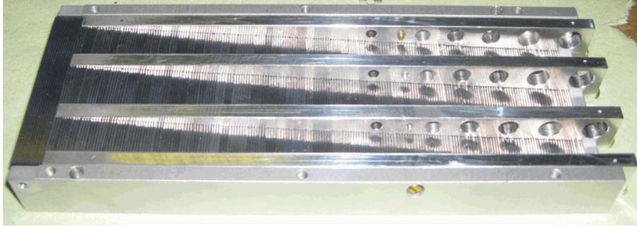
Abbildung 5.1: Die fertige Halblinse bestehend aus 58 Bleiprismenschichten mit von links nach rechts zunehmender Länge, in der Position fixiert durch vier von rechts nach links schmal zulaufende Aluminiumstreben in einem Aluminiumgehäuse
