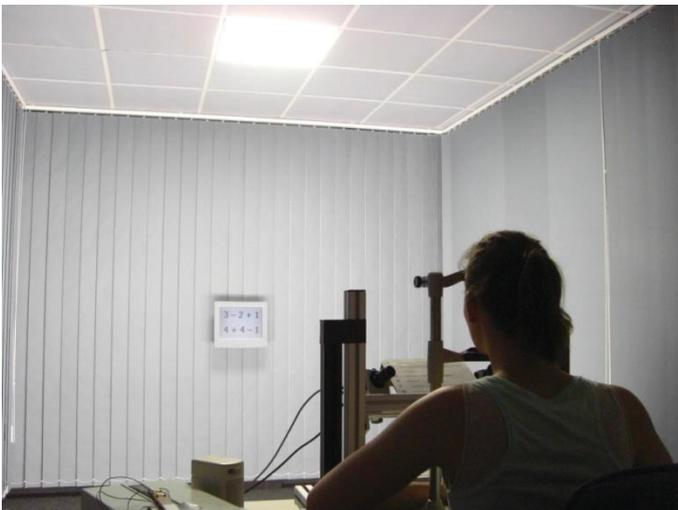
Abbildung 3: Probandin während Aufgabe 1. Die Probanden rechnen zunächst die beiden Zeilenergebnisse aus und subtrahieren anschließend das kleinere vom größeren Ergebnis. Oben im Bild ist die Blendquelle auf eine homogene Leuchtdichte von  $8000 \text{ cd/m}^2$  eingestellt.
