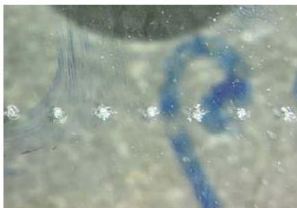
**Abb. 8-14 Sicht auf die Unterseite (Fokusebene) von Brandschutzglas, das mit einer Vorschubgeschwindigkeit  $v_L = 100 \text{ mm / s}$  bearbeitet wurde**
