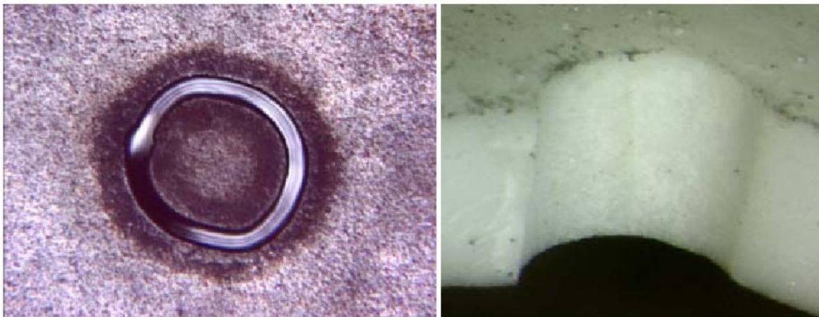
**Abb. 6-7 Links: Sicht auf eine Trepanierbohrung in Saphir mit Kernzylinder, Durchmesser 0,5 mm, Materialstärke 1 mm
