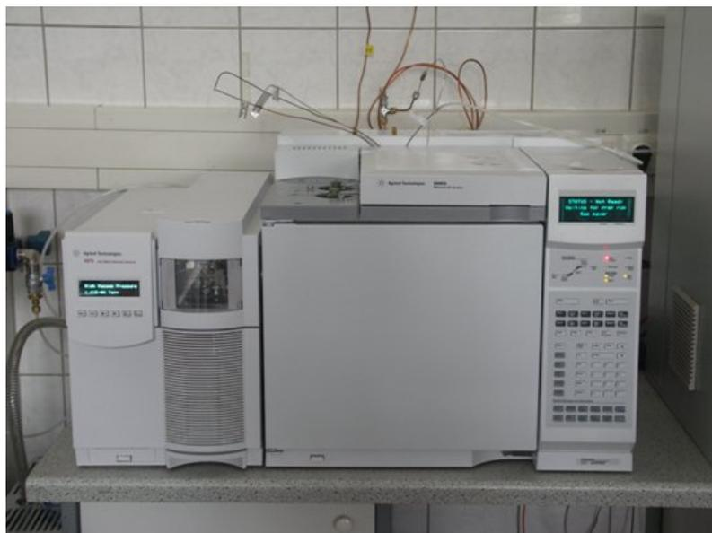
*Abb. 4.1: GC-MS Gasanalyse-System für die Spurengasmessung*
