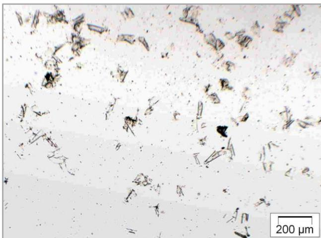
**Abb. 74:** Mikroskop-Aufnahme – Apfeltrester nach 12 Durchläufen im Hochdruckhomogenisator
