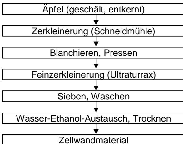
Abb. 6: Schema zur Herstellung von ZM, vereinfacht nach [127]
