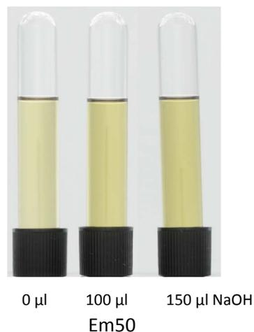
**Abbildung 78:** Farbveränderung der Probe Em50 durch Zugabe von 0, 100 bzw. 150 µl 0,1 m NaOH (Beleuchtung D65, 1000 lx, zentrale Schichtdicke 0,8 cm)
