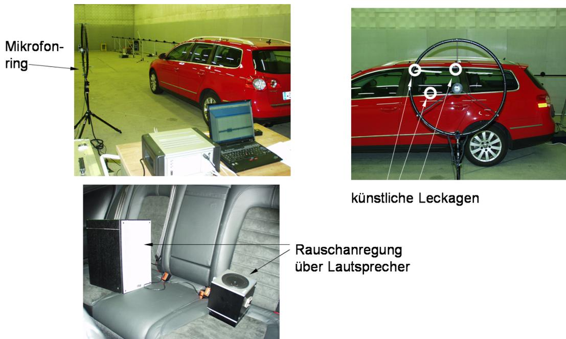
Abbildung 4.31: Messaufbau "Durchschallung": die Anregung erfolgte im Innenraum mit Rauschen über Lautsprecher. Der Messabstand betrug ca. 2.65 m; die Fensterdichtungen wurden mit künstlichen Leckagen versehen.
