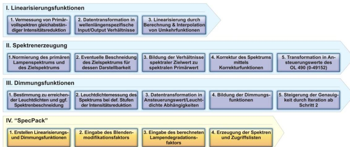
Abbildung 43: Übersicht zentraler Arbeitsschritte zur Spektrenerzeugung und Kalibrierung des OL 490 und Umsetzung als Automatisierung (blau: theoretischer Block, manuelle Umsetzung; orange: automatisierte Umsetzung & Beseitigung negativer Einflüsse aus Abb. 40)
