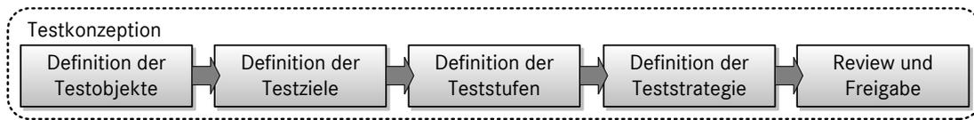
Abbildung 5: Übersicht über die Prozessschritte der Testkonzeption nach [81]
