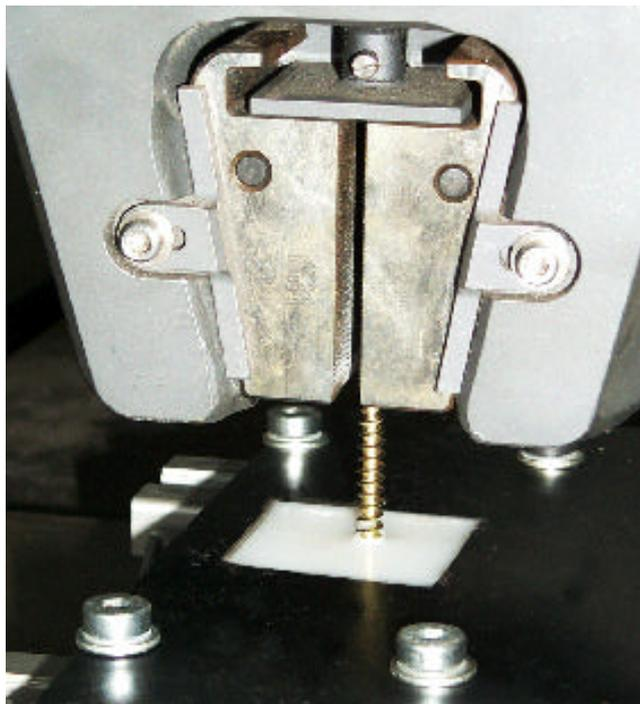
Bild 44: Zugversuch mit eingespannten Werkstoffproben
