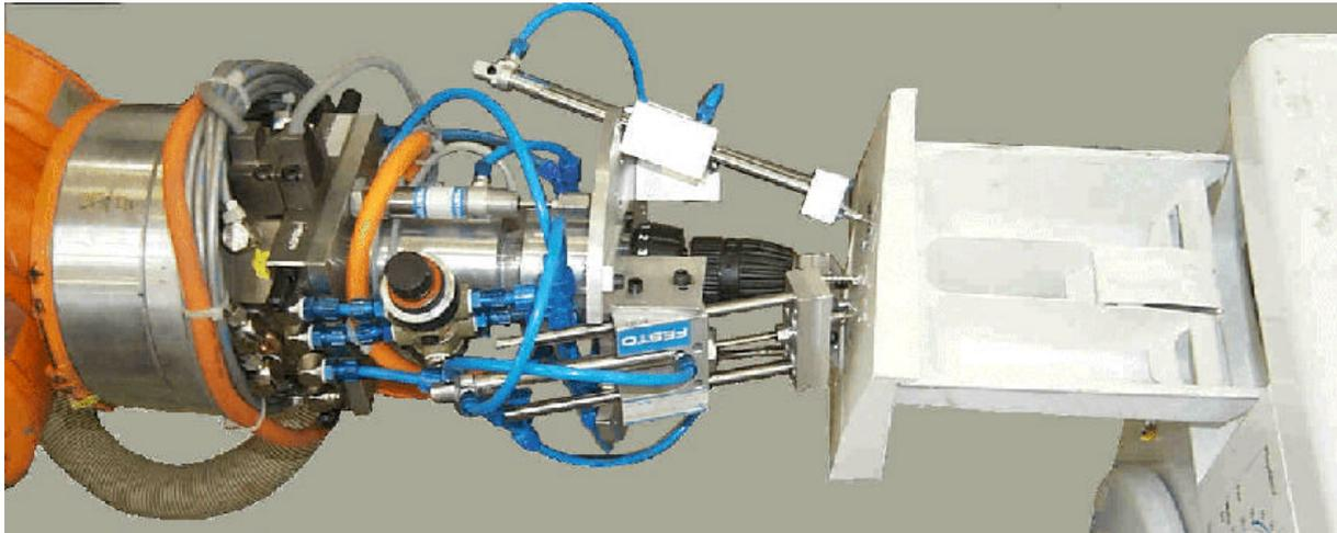
Bild 60: Entnahme der Einspülschublade mit dem realisierten Greifer
