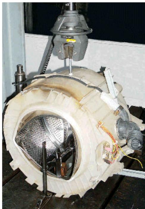
Bild 45: (links) Zugversuche mit dem Werkstoff des Schwingsystems; (rechts) Zugversuche mit gesamtem Schwingsystem
