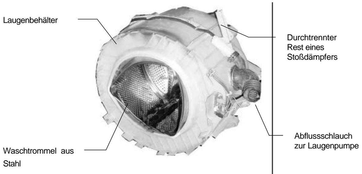
**Bild 61:** Komponenten des Schwingsystems
