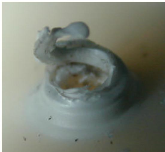
Bild 10: Austragung des Materials durch die Spannut
