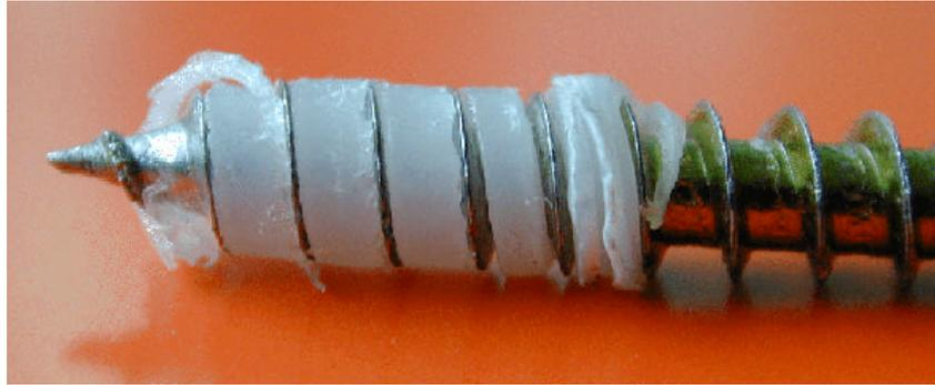
Bild 27: Schraube mit abgescherten Gewindegängen
