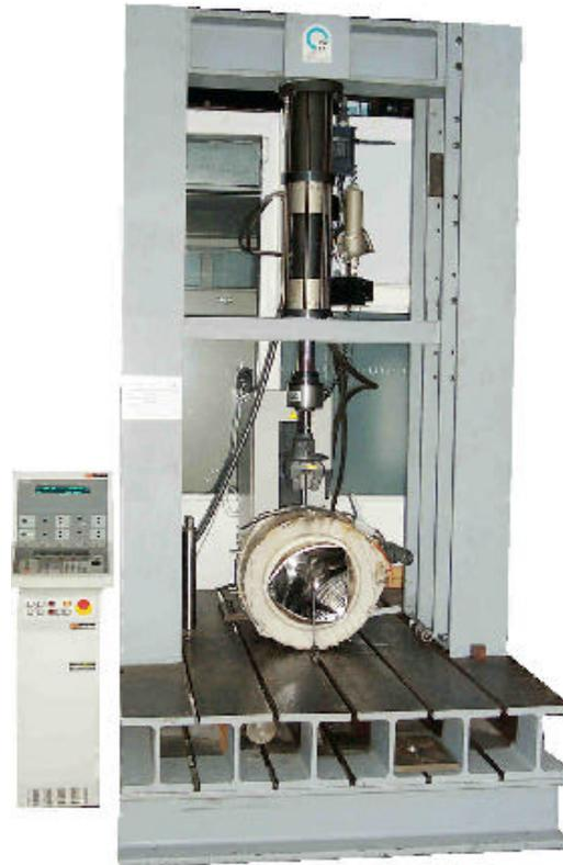
Bild 43: Instron Zug-Druck-Maschine 8500 mit Steuerung
