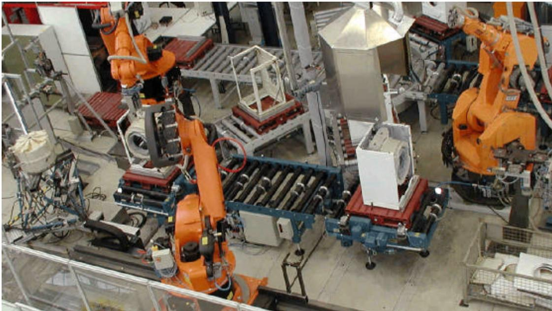
Bild 52: Flexibles Demontagesystem am IWF der TU Berlin [SEL00b]
