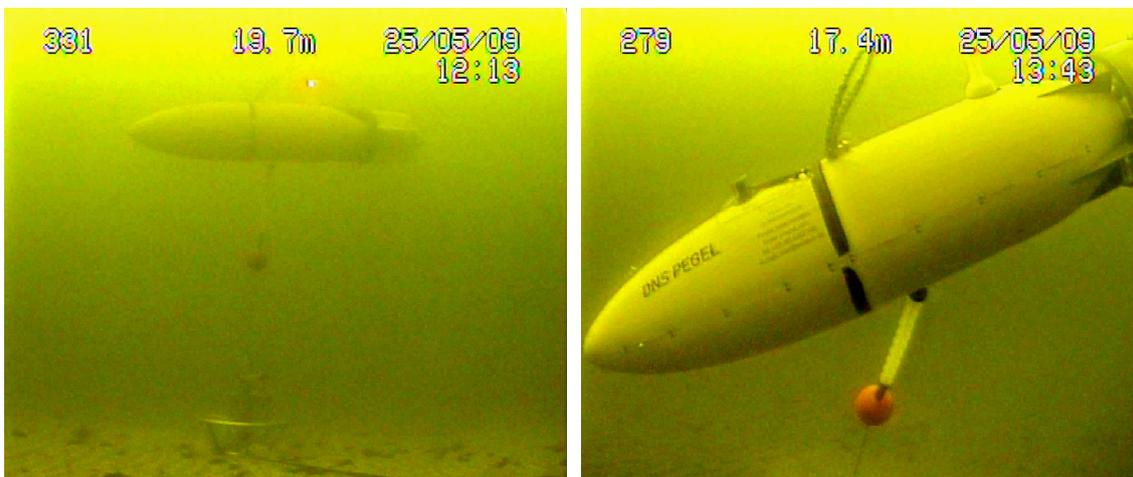
Abbildung 4-24 Links: in 20 m Tiefe verankertes, horizontal ausgerichtetes Fahrzeug, rechts: einstellbarer Neigungswinkel durch Verlagerung der Trimmflüssigkeit zum Bug
