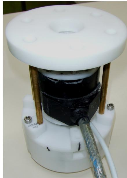
**Abbildung 2-17** Prototyp einer Kreiselpumpe für den Querstrahlantrieb zur Bestimmung des erzielbaren Schubs unter Einsatz von verschiedenen Radiallaufrädern, Austrittsdüsen und Ansaugquerschnitten
