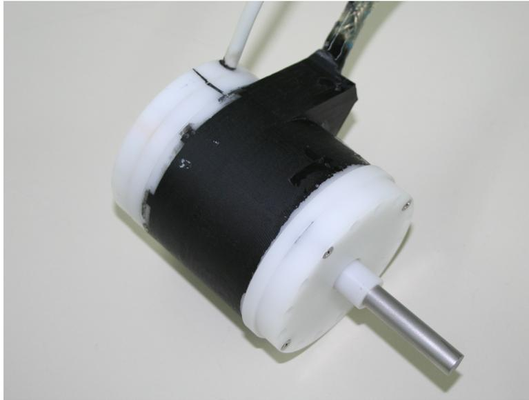
**Abbildung 3-47** Überarbeiteter, druckneutraler Unterwasser-Synchronmotor
