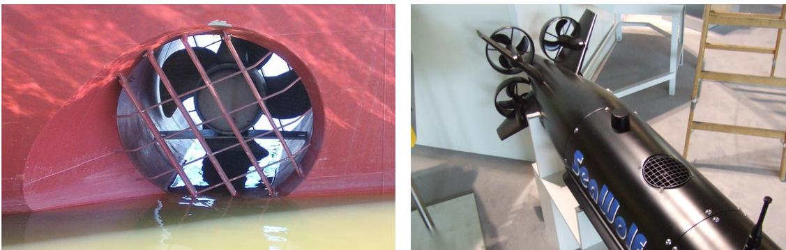
**Abbildung 2-7** Links: Bugstrahlruder eines Schiffes mit Gitter zur Wirbelvermeidung
