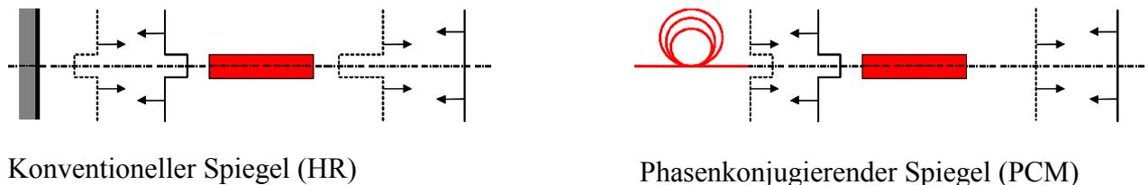
**Abbildung 1.1:** Schematische Darstellung zur Veränderung der Phasenflächen bei Doppeldurchgang durch Laserverstärker (Durchgezogene Linien: Einfallende Wellenfront, Gestrichelte Linien: Reflektierte Wellenfront. Links: Reflexion an einem konventionellen Spiegel. Rechts: Reflexion an einem phasenkonjugierenden Spiegel).
