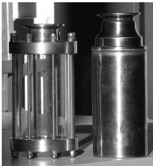
**Abb. 4.2: Versuchsbehälter: Glasreaktor (links) und Metall Dewar (rechts).**
