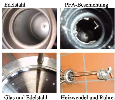
**Abb. 5.14: Reaktoreinbauten und Oberflächen des Dewars und Glasreaktors.**
