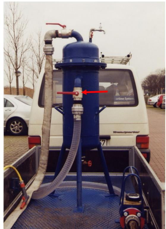
**Abbildung 2.3: Schematische Darstellung und Funktionsweise der Filtrierapparatur F2. (Zeichnung links aus DVGW, 1997), Pfeil - Abflusshahn**
