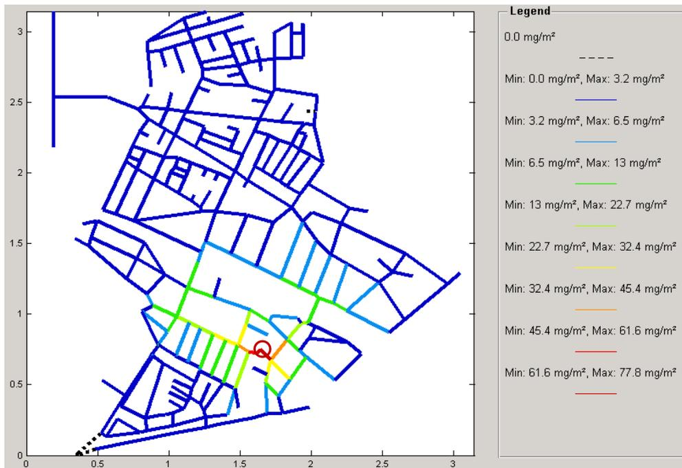
**Abbildung 3.7: Ablagerungsbildung (durch am Wasserwerk eingetragene Partikel) innerhalb eines Tages. Legende: Roter Kreis: Wasserwerk, Skalierung der Achsen – 0,5 km (aus: RIPL & UHL, 2013)**
