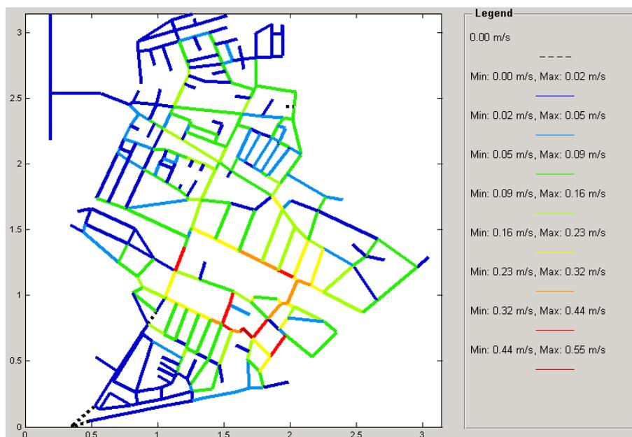
**Abbildung 3.1: Mittlere tägliche Strömungsgeschwindigkeiten im Verteilungsnetz GWT-15B. Skalierung der Achsen – 0,5 km; aus RIPL & UHL (2013)**
