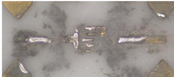
**Abbildung 2.33:** Interdigital Kapazität nach Spannungsdurchschlag.
