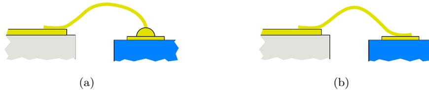
**Abbildung 2.35:** Darstellung der Verbindungstechnik für (a) Ball-Bond und (b) Wedge-Bond.
