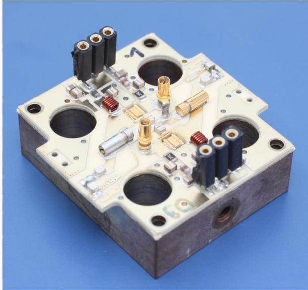
*Abbildung 6.5 Leistungoszillator des Plasmaquellenmoduls*
