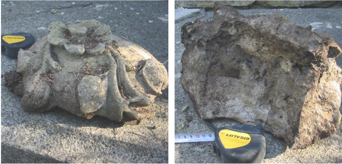
Abb. 108 und 109: Abgesprengtes Vasenbruchstück. Erkennbar ist die geringe Verbindung der Vorsatzmischung mit dem Kernbeton. Friedhof Buchholz,, Berlin. Entstehungszeit um 1895.
