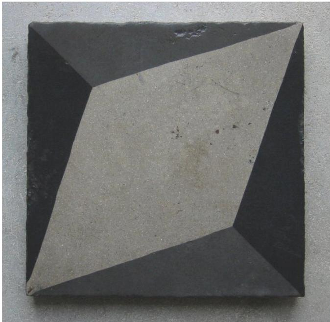
*Abb. 57: Dreifarbige Betonplatte, Typ I, um 1900*
