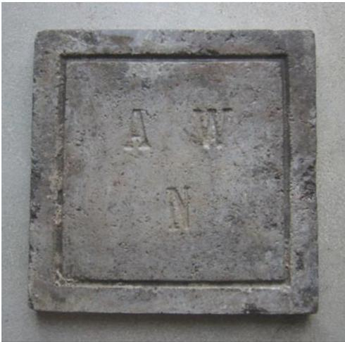
Abb. 58a: Dreifarbige Betonplatte, Typ I, um 1900, Rückseite
