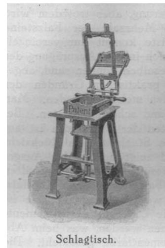
Abb. 43: Schlagtisch zur Herstellung von Dachsteinen
