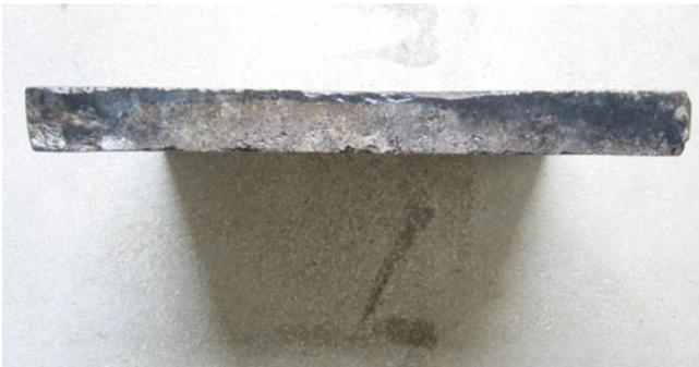
Abb. 58b: Dreifarbige Betonplatte, Typ I, Seitenansicht einer schwarz eingefärbten Seite, erkennbar sind hohe Maßtoleranzen hinsichtlich der Plattenstärke sowie der Gleichmäßigkeit des Vorsatzbetons.
