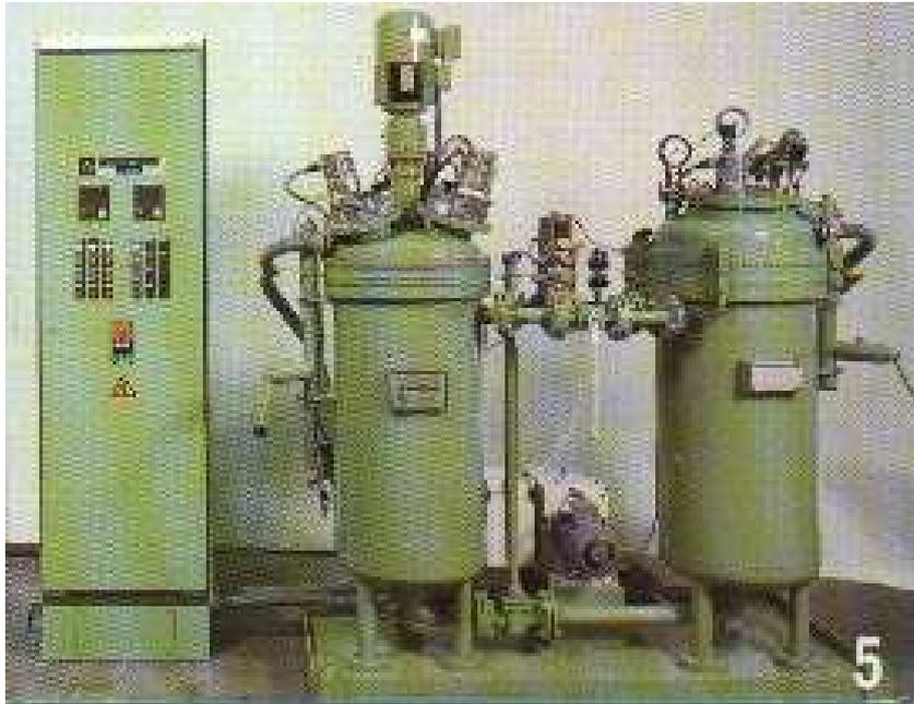
**Abb. 7-2 Laboranlage zum Vakuum - Druck - Imprägnieren**
