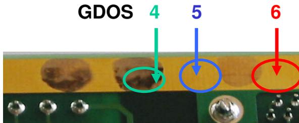
Abbildung 8.18: stellenweise Au-gestripptes Ni:P/Au einer Black-Pad-verdächtigen Probe der Baugruppe 2 (BG2)
