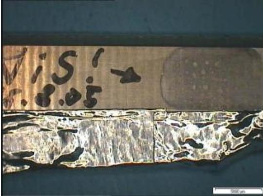
Ni:P/Au-Streifen der Platine BG2, lokal Au-gestrippt, betraufelt mit NiS, zur EDX-Analyse von S [IZM]
