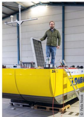
Elektromotor und Fotozellen, GPS, Laserradar und Funk: Tim Holzki präsentiert einen A-SWARM-Prototypen.
