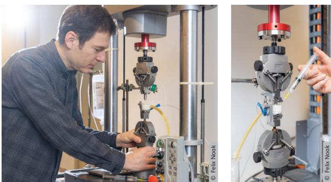
Reinhard Meinke kontrolliert die elektrodynamische Prüfmaschine und befeuchtet eine Probe (rechts), die Ermüdungsversuchen ausgesetzt wird.
