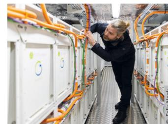
Akkuraum im Schiffsbauch: Rund 3000 Meter elektrische Leitungen wurden verlegt und mehr als 2000 Sensoren eingebaut.
