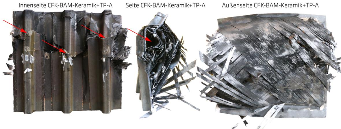
Abbildung 3.62: Innenseite, Seitenansicht und Außenseite des Omega-stringerversteiften CFK Schalenprüfkörpers CFK-BAM-Keramik+TP-A mit integrierter Faserkeramiklage und integrierten Thermoplastfolien nach der Feuerwiderstandsprüfung
