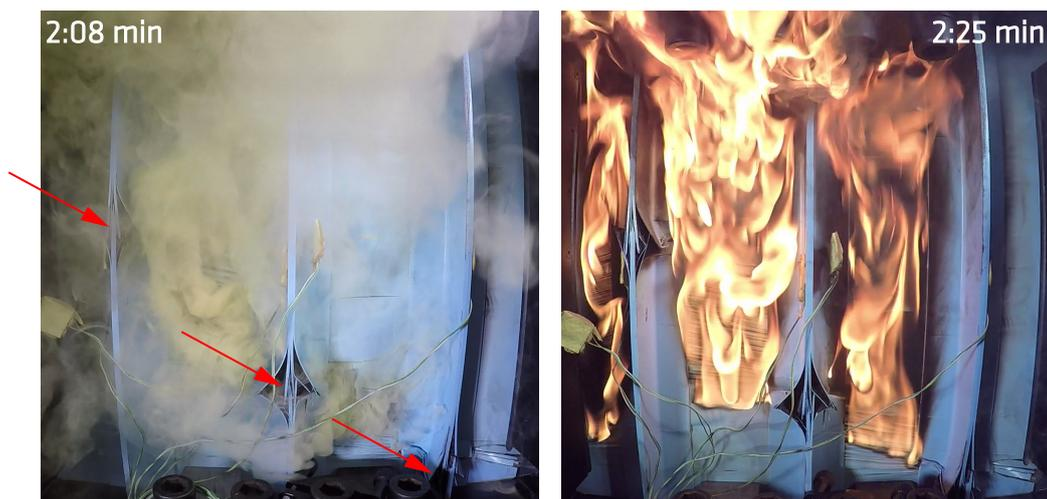
Abbildung 3.39: Innenseite des T-stringerversteiften Rumpfschalenprüfkörpers CFK-T50B während der Feuerwiderstandsprüfung bei Lastniveau B zu ausgewählten Zeitpunkten des Versuchs
