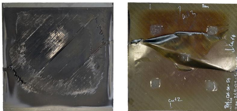
Abbildung 3.15: CFK Schale nach Feuerwiderstandsprüfung; links: dem Vollbrand ausgesetzte Schalenaußenseite, rechts: Schaleninnenseite
