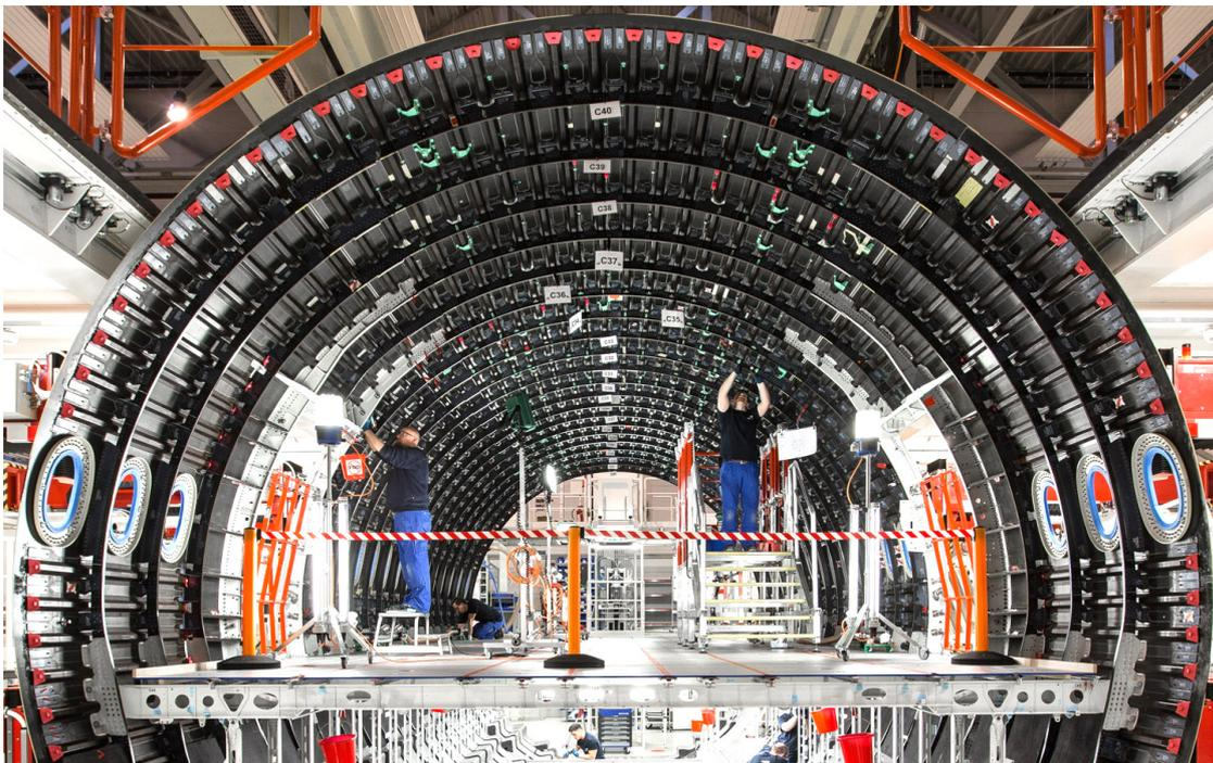
Abbildung 2.1: Versteifte CFK Rumpfschnitt in der Montage bei Premium AEROTEC in Nordenham, ©Premium AEROTEC ([https://www.premium-aerotec.com /medien /pressebilder/](https://www.premium-aerotec.com/medien/pressebilder/))
