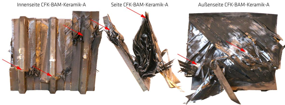
Abbildung 3.59: Innenseite, Seitenansicht und Außenseite des Omega-stringerversteiften CFK Schalenprüfkörpers CFK-BAM-Keramik-A mit integrierter Faserkeramiklage nach der Feuerwiderstandsprüfung
