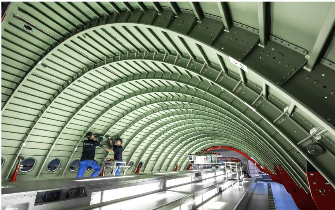
Abbildung 2.2: Versteifte Aluminium Seitenschale in der Montage bei Premium AEROTEC in Nordenham, ©Premium AEROTEC (<https://www.premium-aerotec.com/medien/pressebilder/>)
