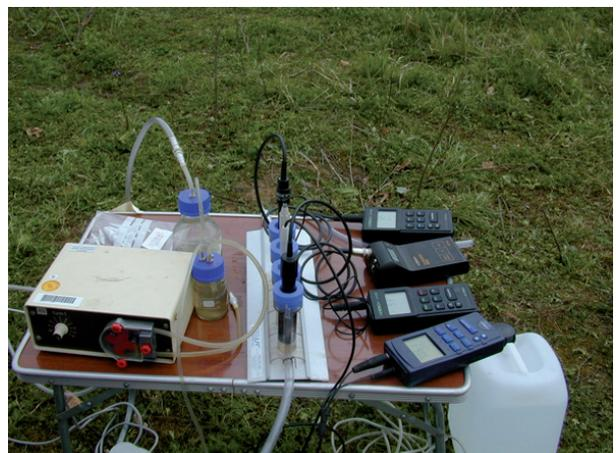
▲ **Abb. 20:** Vor-Ort-Analytik mit Messgeräten, Vakuumflaschen, Durchflusszelle und Schlauchpumpe (Foto: Anette Spinola)
