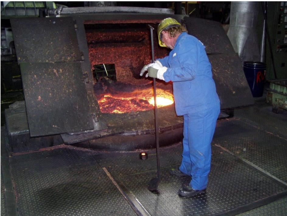
*Bild 2: Exposition durch Wärmestrahlung an einem Metallschmelzofen*
