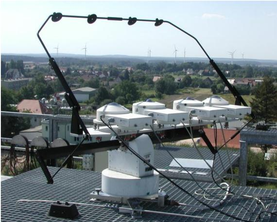
*Abb. 4: Pyrgeometerreferenzgruppe auf dem Dach der Strahlungsmesszentrale des MOL*
