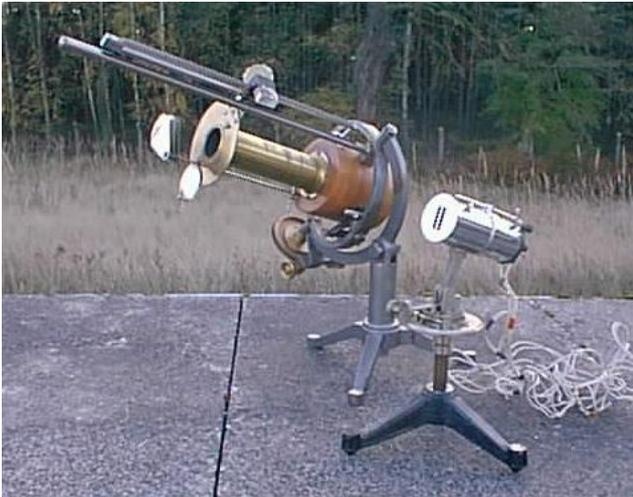
*Abb. 1: Angström-Pyrheliometer (vorn) und Silverdisk-Pyrheliometer (hinten) als Transferstandard der Smithsonian-Skala*
