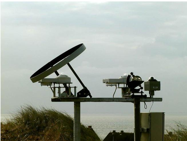
*Abb.6: Strahlungsmessungen an der Wetterstation List auf Sylt um 1990. mit den beiden Pyranometern für die Global- und diffuse Sonnenstrahlung sowie dem Campbell-Stokes und dem SONie zur Sonnenscheindauermessung (vorn rechts)*
