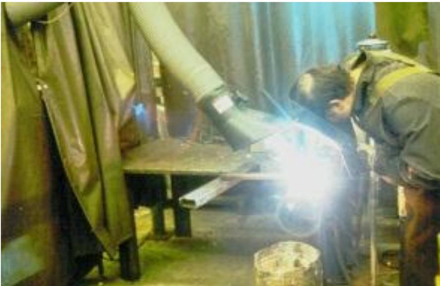
*Bild 1: UV-, sichtbare und IR-Strahlenemissionen beim Schweißen*
