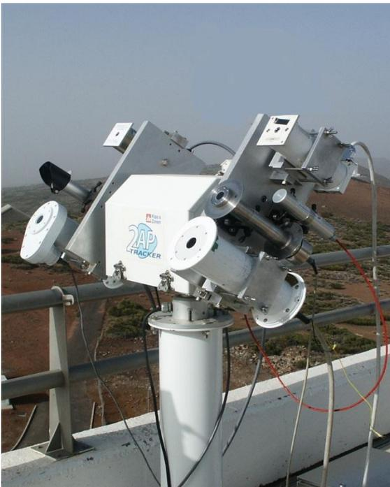
*Abb. 2: Diverse Pyrheliometer mit der Gruppe der Referenzpyrheliometer beim Vergleich vor Sonne*
