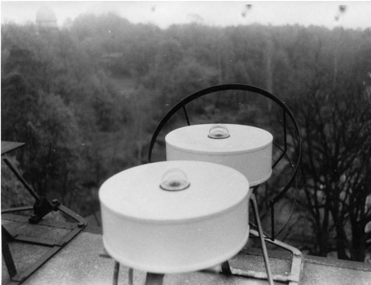
Abb. 5: Pyranometer zur Messung der Global- und diffusen Sonnenstrahlung auf dem kleinen Turm des Meteorologischen Observatoriums Potsdam um 1937
