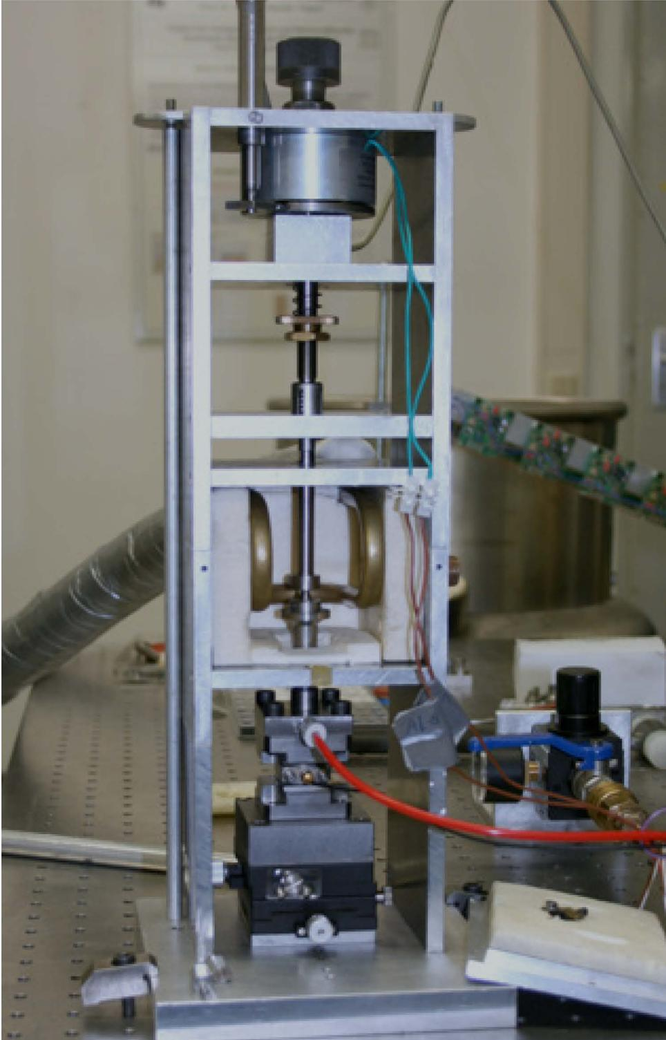
Abbildung 35: Versuchsapparatur Variante B, geöffnete Prüfkammer mit eingelegter Materialprobe, Hubeinheit bestückt mit einem zylindrischen Indenter mit dem Radius  $2,5\text{ mm}$ , der Indenter und die Materialprobe befinden sich im Kontakt. Der einstellbare Temperaturbereich reicht von ca.  $-80\text{ °C}$  bis  $80\text{ °C}$ , Kühlung erfolgt durch gasförmigen Stickstoff, welcher über ein Rohrleitungssystem um den Probenhalter geführt und direkt in die Prüfkammer eingeleitet wird.
